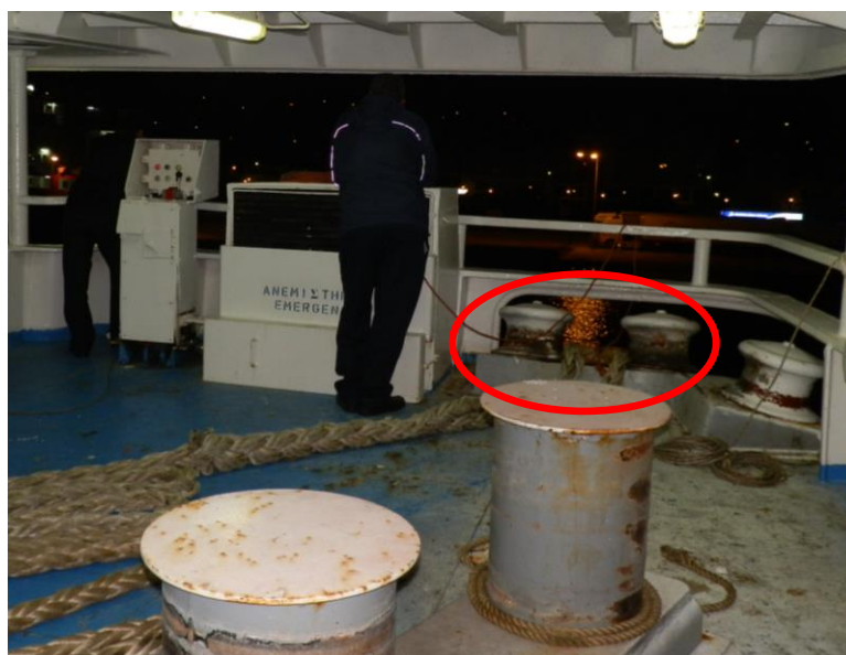
Εικόνα 5: Άποψη του πρυμναίου αριστερού χώρου του καταστρώματος πρόσδεσης. Επισημαίνονται (κυκλωμένοι με ερυθρό χρώμα) οι τονοδηγοί μέσω των οποίων διερχόταν ο πρυμναίος κάβος, στο σημείο όπου τραυματίστηκε ο ναύτης του πλοίου
