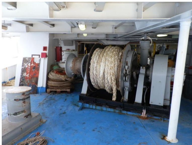
Εικόνα 4: Ο μηχανισμός περιτύλιξης (βίντσι) στον οποίο ήταν στερεωμένος με φρένο ο κάβος της πρυμναίας αριστερής διάταξης πρόσδεσης του πλοίου.
